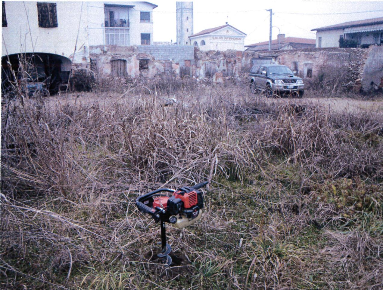
**Foto N.1 : Esecuzione del Sondaggio N.1 con trivella nel settore meridionale dell'area di spostamento**
