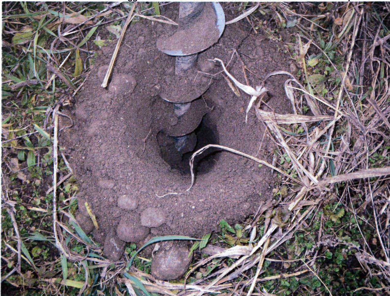
**Foto n 2 : Prelievo del campione N.1 fino alla profondità di -1.0mt nel settore meridionale dell'area**
